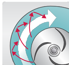
Стандартное рабочее колесо не предполагает однородность потока.
