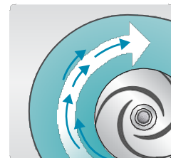
Рабочее колесо Flygt сохраняет однородность потока, удерживая твердые частицы внутри жидкости.
