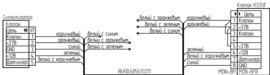
Рисунок В.5 – Схема подключения клапана КЗЭУГ с разъемом MDN8FR.
