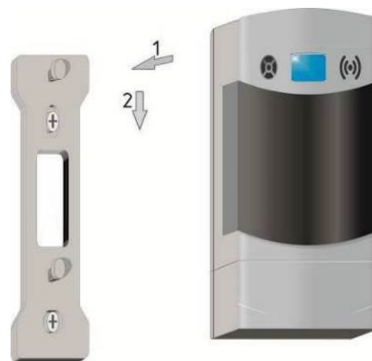
Рисунок 5 – Установка сигнализатора на монтажную панель
