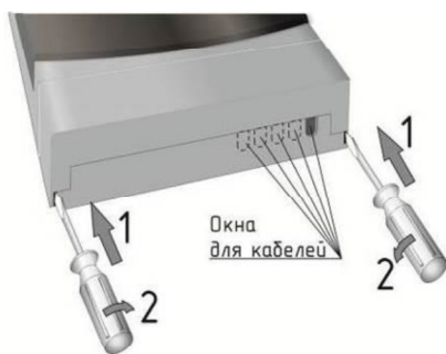
Рисунок 4 – Снятие крышки клеммного отсека
