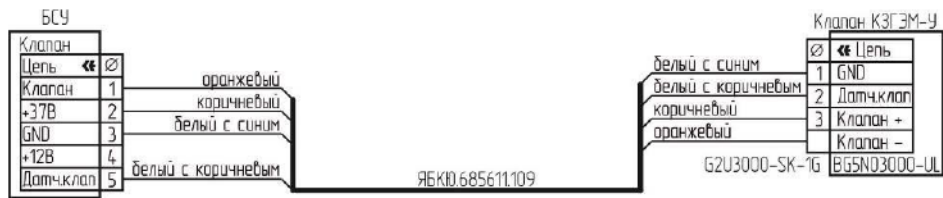
Рисунок Б.6 – Схема подключения клапана КЗГЭМ-У с разъемом BG5N03000-UL.
