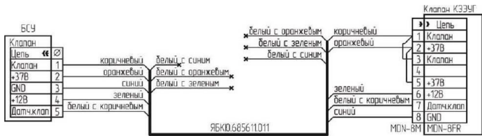
Рисунок Б.7 – Схема подключения клапана КЗЭУТ с разъемом MDN-8FR.
