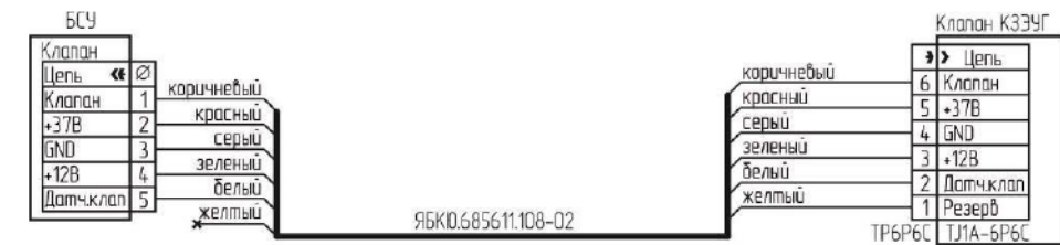
Рисунок Б.8 – Схема подключения клапана КЗЭУТ с разъемом TJ1A-6P6C.
