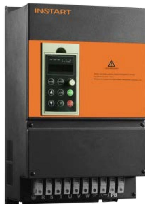
Основная функция – **регулирование скорости и момента электродвигателя.** Векторное управление асинхронными и синхронными двигателями. Диапазон мощности от 0,75 кВт до 630 кВт Применение в различных областях (насосы, станки, вентиляторы, конвейеры и т.д)
