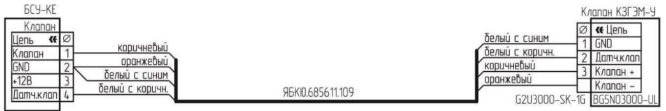
Рисунок Б.5 – Типовая схема подключения клапана К3ГЭМ-У с разъемом BG5N03000-UL
