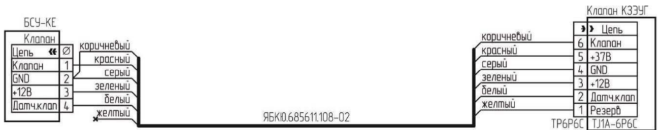
Рисунок Б.7 – Типовая схема подключения клапана К3ЭУГ с разъемом TJ1A-6P6C
