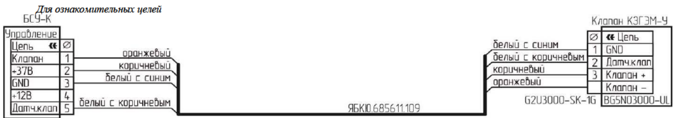
Рисунок Г.6 – Типовая схема подключения клапана КЗГЭМ-У с разъемом BG5N03000-UL
