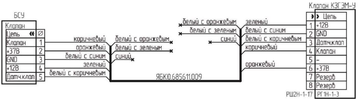
Рисунок Г.7 – Типовая схема подключения клапана КЗГЭМ-У с разъемом РГ1Н-1-3
