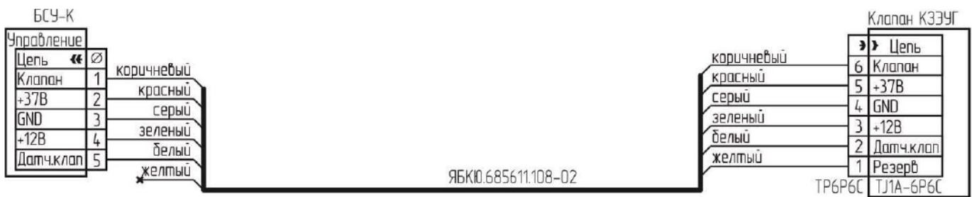
Рисунок Г.8 – Типовая схема подключения клапана КЗЭУГ с разъемом ТЛ1А-6Р6С
