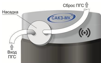
Рисунок Е.2 – Установка насадки для подачи ПГС
