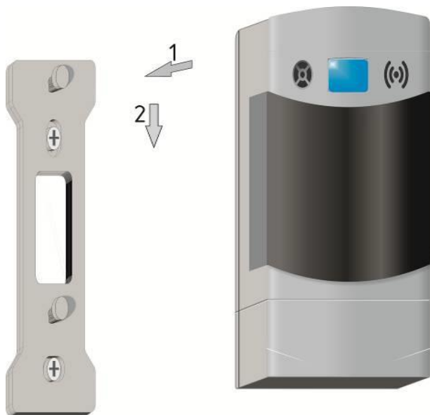
Рисунок В.3 – Установка сигнализатора на монтажную панель
