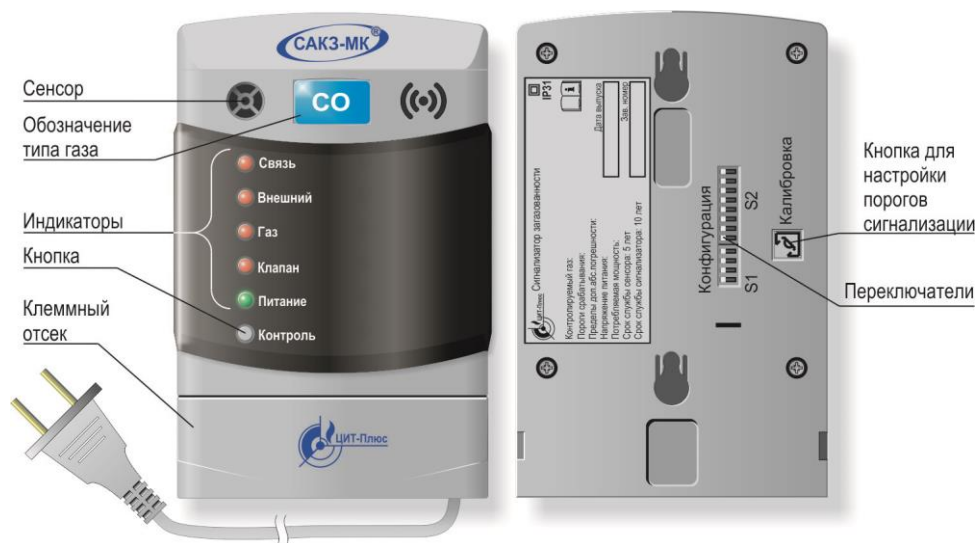
Рисунок 1 – Внешний вид сигнализатора (монтажная панель условно не показана).
