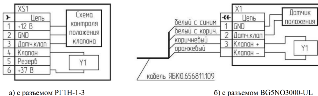
Рисунок 5 – Клапан КЗГЭМ-У. Схема электрическая принципиальная.
