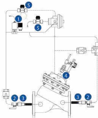
Клапан защищает насос от резких скачков давления, возникающих при запуске и остановке насоса. Электрическое управление открывает и закрывает кран при запуске и остановке насоса соответственно. Клапан работает как плавно закрывающийся обратный клапан, тем самым предотвращая обратный поток воды через насос.
