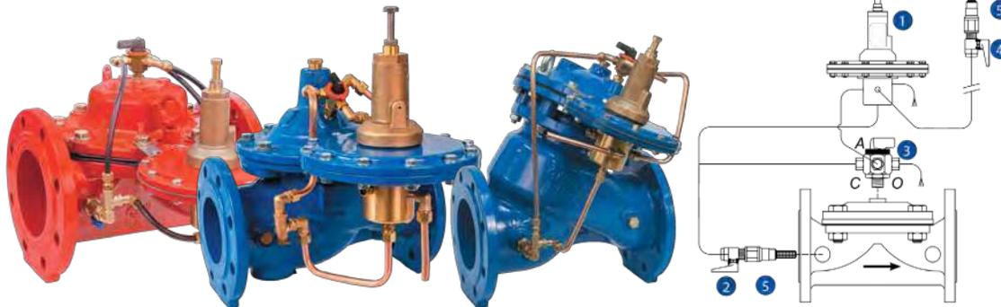
Клапан автоматически поддерживает постоянный уровень жидкости в резервуаре. Установка поплавка и длинные импульсные линии не требуются, пилотный регулятор прямого действия реагирует на отклонение статического давления в резервуаре. Возможно исполнение с двумя пилотами для поддержания крайних значений уровня жидкости (мин/макс). Время реагирования может быть отрегулировано для предотвращения гидроудара в момент закрытия клапана.
