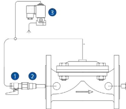
В качестве пилота используется электромагнитный (соленоидный) клапан, что позволяет управлять главными клапанами больших диаметров с помощью внешнего сигнала без использования габаритных и мощных приводов.
