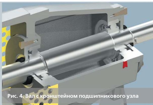
Рис. 4. Вал с кронштейном подшипникового узла
