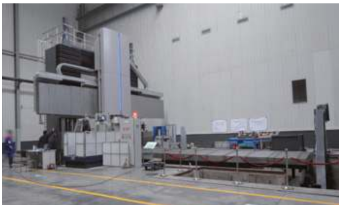
Шестиосевой, пятиосевой порталный фрезерный и расточный обрабатывающий центр
