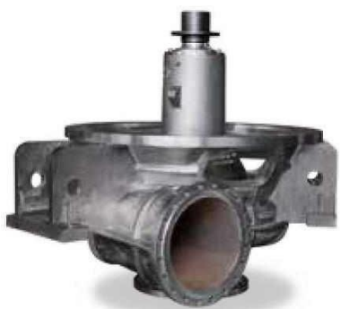
Насос второго контура
