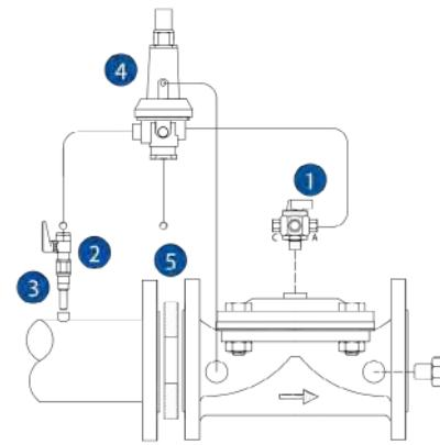
На входе в главный клапан устанавливается межфланцевая диафрагма, перепад давления на которой пропорционален расходу среды.
