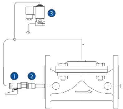
В качестве пилота используется электромагнитный (соленоидный) клапан, что позволяет управлять главными клапанами больших диаметров с помощью внешнего сигнала без использования габаритных и мощных приводов.
