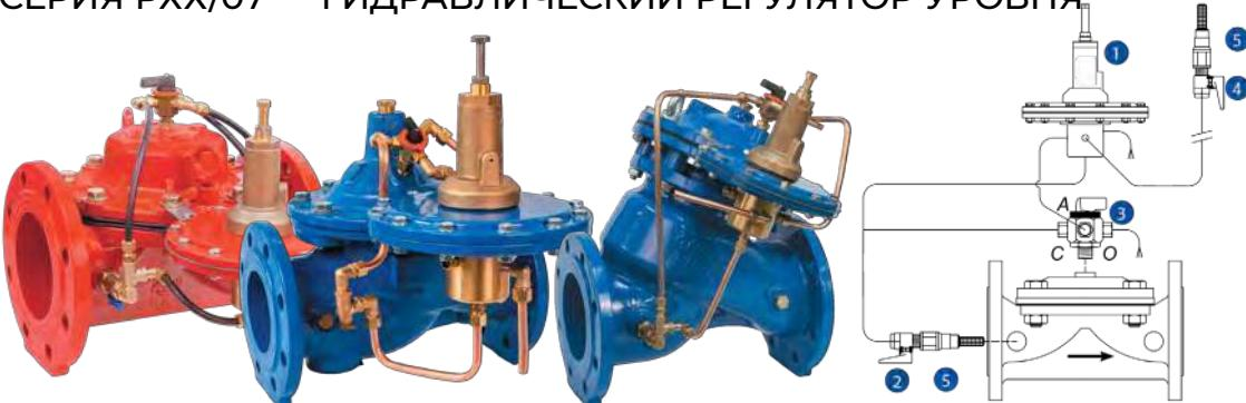
Клапан автоматически поддерживает постоянный уровень жидкости в резервуаре. Установка поплавка и длинные импульсные линии не требуются, пилотный регулятор прямого действия реагирует на отклонение статического давления в резервуаре. Возможно исполнение с двумя пилотами для поддержания крайних значений уровня жидкости (мин/макс). Время реагирования может быть отрегулировано для предотвращения гидроудара в момент закрытия клапана.
