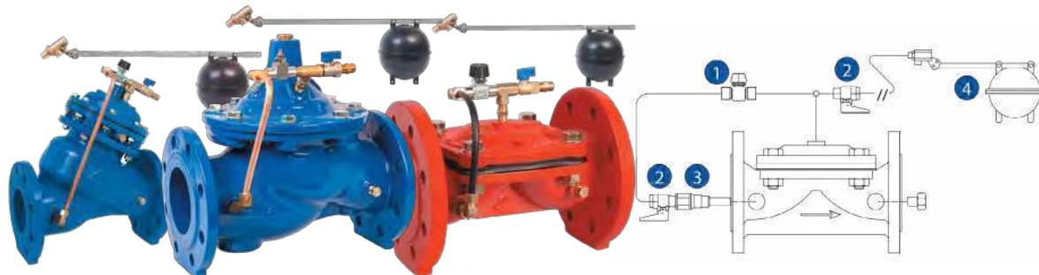
Клапан автоматически поддерживает постоянный уровень жидкости в резервуаре. В качестве пилота используется внешний поплавковый клапан. Время реагирования может быть отрегулировано для предотвращения гидроудара в момент закрытия клапана.
