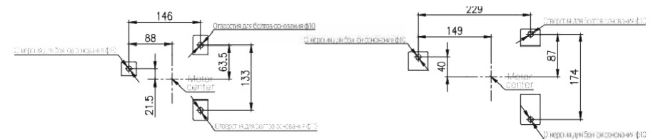
Размер отверстия под болты основания для серий RA, RH, RP, RT
