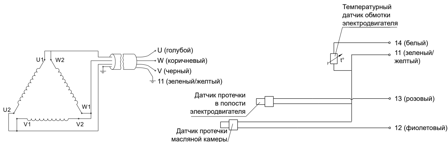
Схема подключения погружных канализационных насосов WQ/ES (треугольник)
