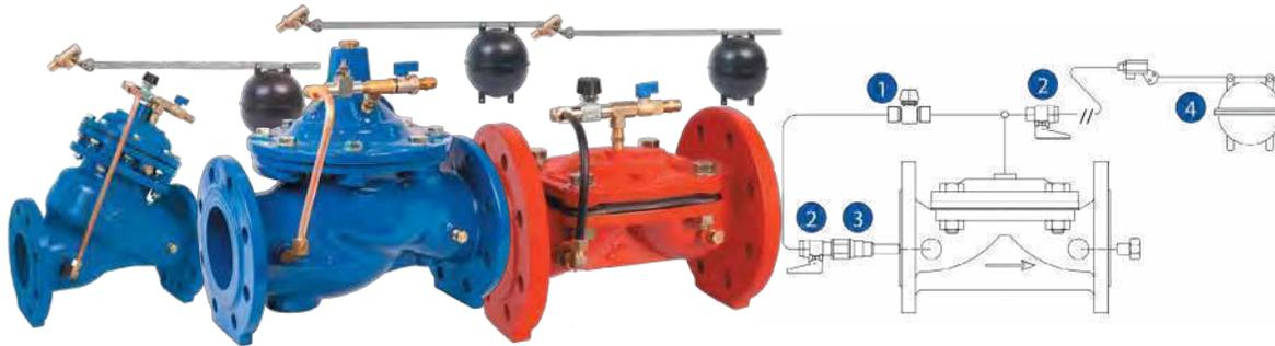
Клапан автоматически поддерживает постоянный уровень жидкости в резервуаре. В качестве пилота используется внешний поплавковый клапан. Время реагирования может быть отрегулировано для предотвращения гидроудара в момент закрытия клапана.
