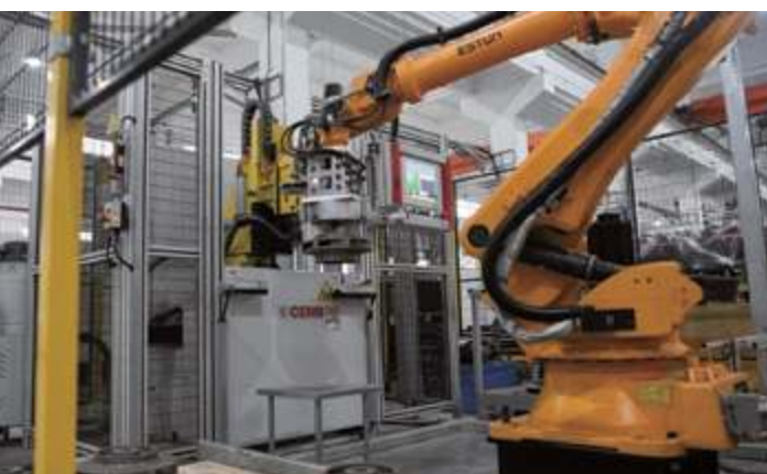
Оборудование для автоматической балансировки рабочего колеса CEBR
