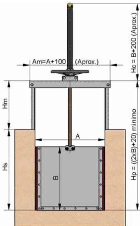
Обычно затворы СА устанавливаются в канал при помощи бетонирования, поэтому, как мы уже упоминали ранее, канал должен иметь соответствующие канавки, куда вставляется затвор для последующего бетонирования. На рисунках приводятся размеры канавок.
