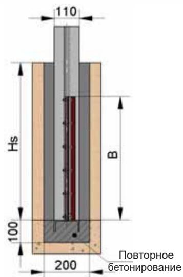
Если канал не имеет соответствующих канавок для бетонирования, существует возможность анкерного или химического крепления корпуса, но следует иметь в виду, что проход канала при этом уменьшается примерно на 80 мм.
