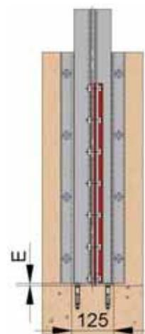
На дно канала крепится гладкая полоса, обеспечивающая нижнее уплотнение затвора. Толщина полосы (параметр Е) зависит от ширины затвора (А) и определяется по таблице.
