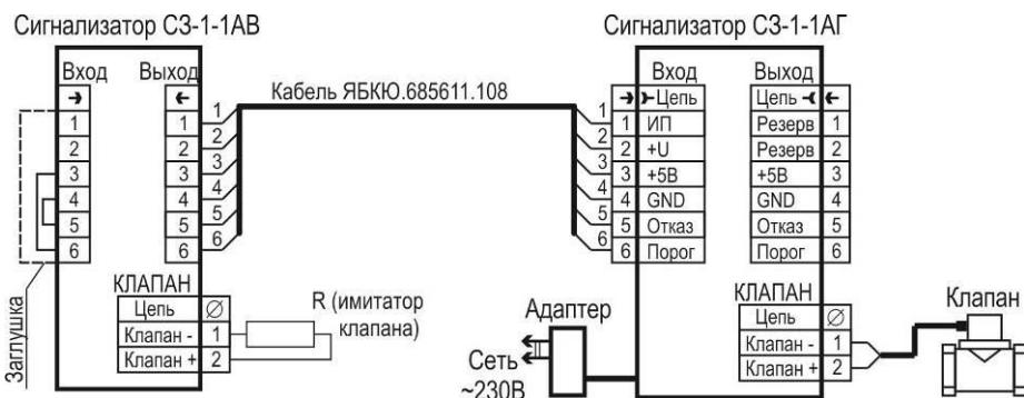
Рисунок Г.2 – Типовая схема включения сигнализатора С3-1-1АВ
