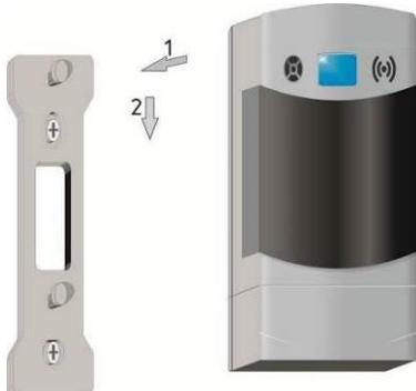
Рисунок 3 – Установка сигнализатора
