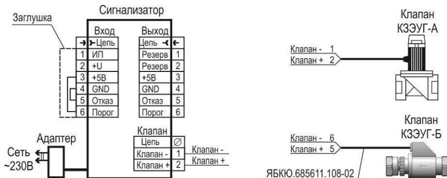
Рисунок Г.1 – Типовая схема включения сигнализатора С3-1-1АГ
