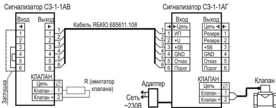
Рисунок Г.2 – Типовая схема включения сигнализатора СЗ-1-1АВ
