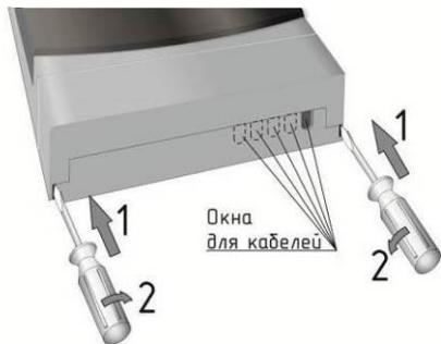
Рисунок 2 – Снятие крышки
