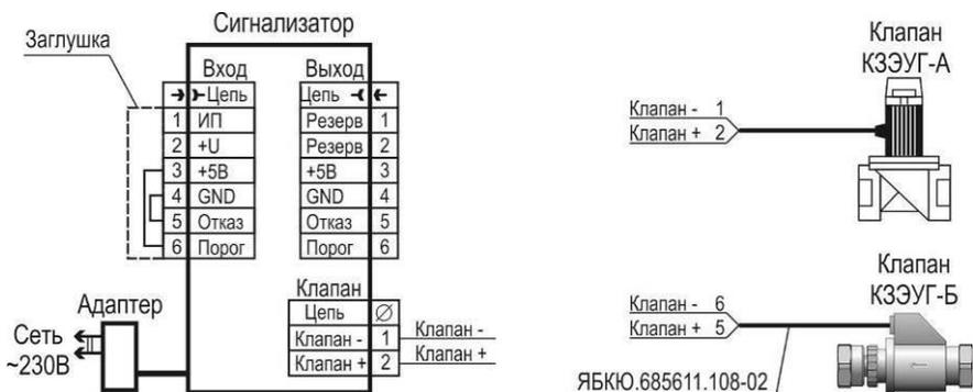
Рисунок Г.1 – Типовая схема включения сигнализатора СЗ-1-1АГ
