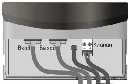
Рисунок 4 – Расположение разъемов в клеммном отсеке
