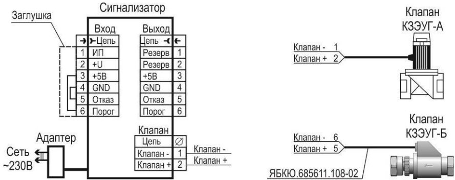
Рисунок Г.1 – Типовая схема включения сигнализатора СЗ-3-1АГ
