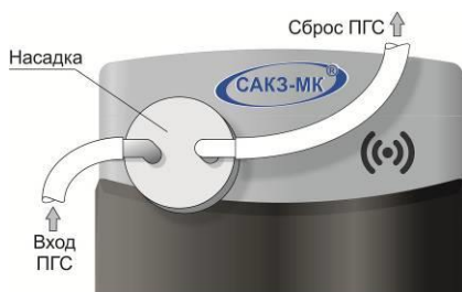
Рисунок Д.1 – Установка насадки для подачи ПГС
