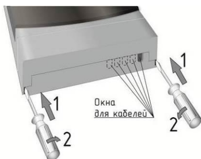
Рисунок 2 – Снятие крышки клеммного отсека
