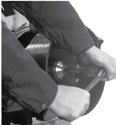
4. Вытяните муфту, используя съемник с тремя захватами. Используйте съемник 84 20 49 и захваты 84 14 45.
