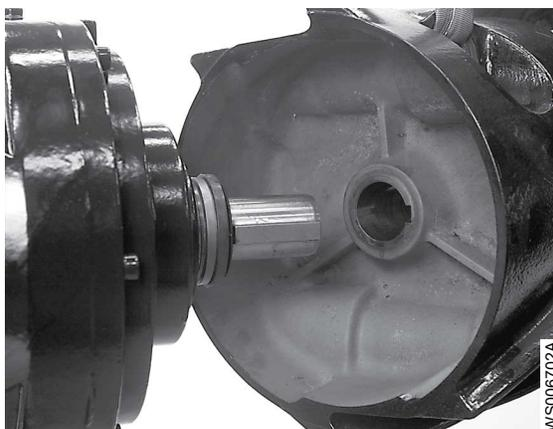
4. Напрессуйте поддерживаемую канатом муфту на вал с помощью резьбовой шпильки, гайки и шайбы.
