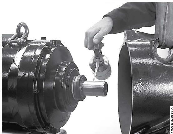
3. Поверните вал таким образом, чтобы шпонка вала совпала с пазом муфты.
