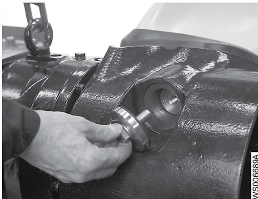
9. Затяните винт до момента 150 Нм (111 фунто-футов).
