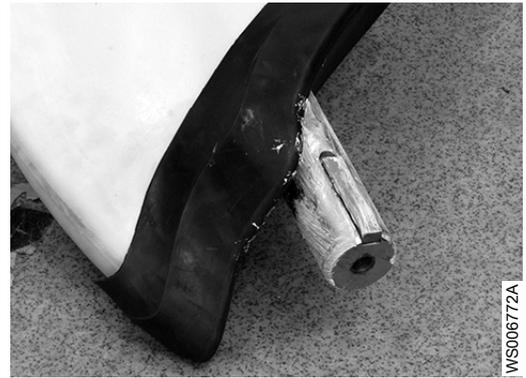
3. Установите демпфер (a) и шпонку (b) на вал лопасти.
