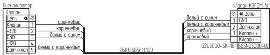
Рисунок В.4 – Схема подключения клапана КЗГЭМ-У с разъемом BG5N03000-UL.
