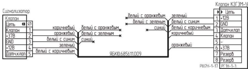
Рисунок В.3 – Схема подключения клапана КЗГЭМ-У с разъемом RJ45-1-3.
