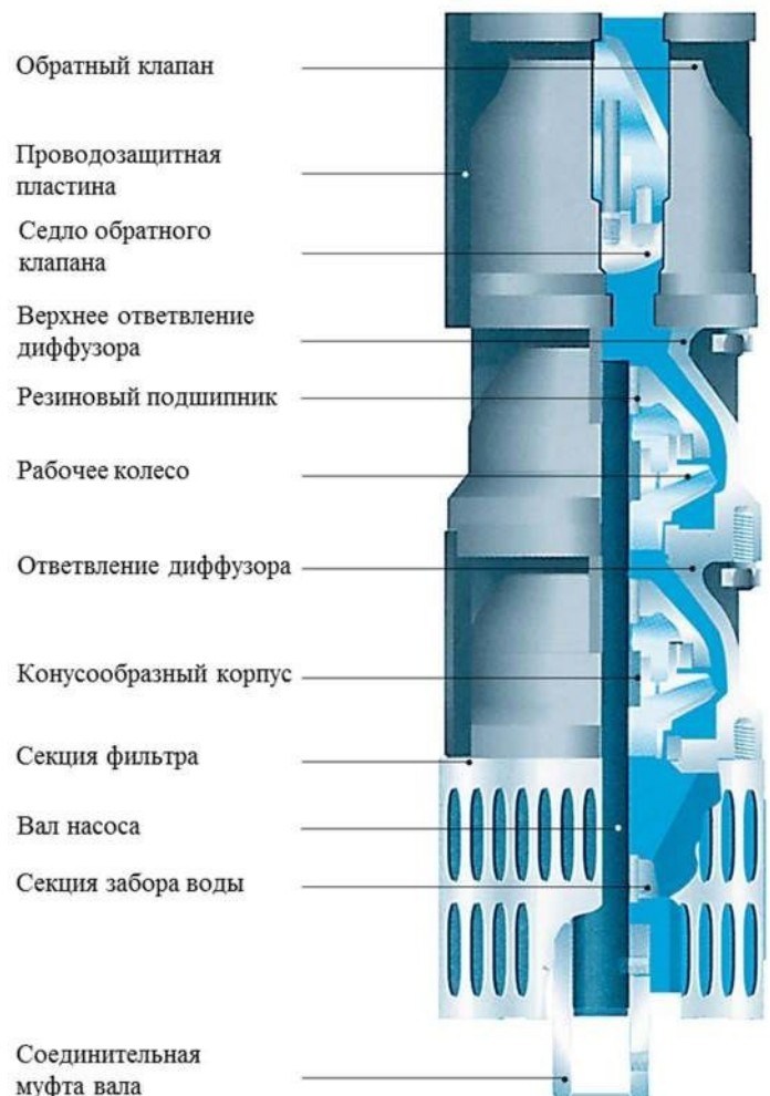
Рисунок 14. Структура насосной части погружного агрегата насосного SJ
